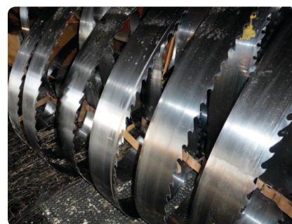
Rena sågblad efter 36 timmars drift.
